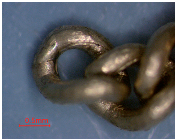
Figura 7 - Campione 7 995W 7,2 ms - Buccia d'arancia molto evidente
