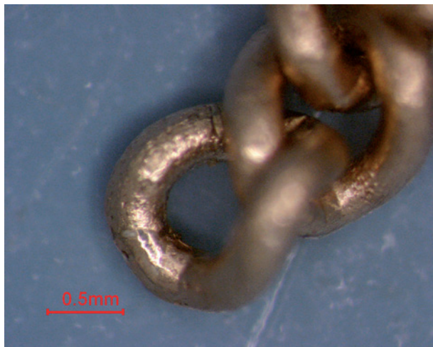
Figura 6 - Campione 6 1374W 3,7 ms - Buccia d'arancia evidente
