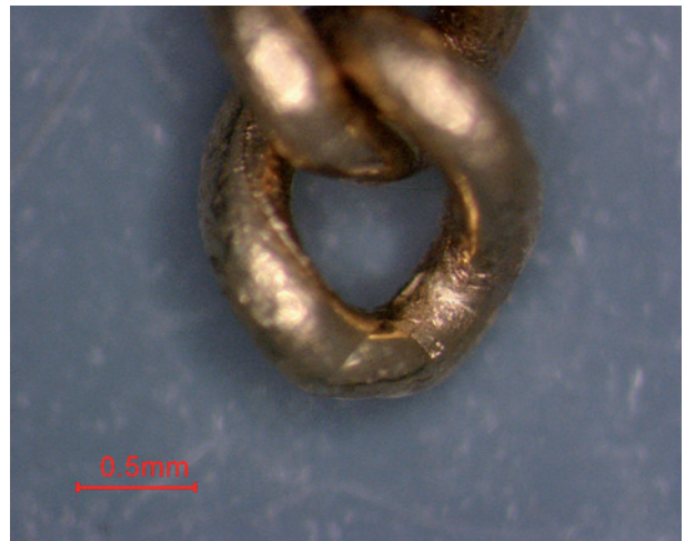
Figura 2 - Campione 2 1148W 6 ms - Buccia di arancia evidente
