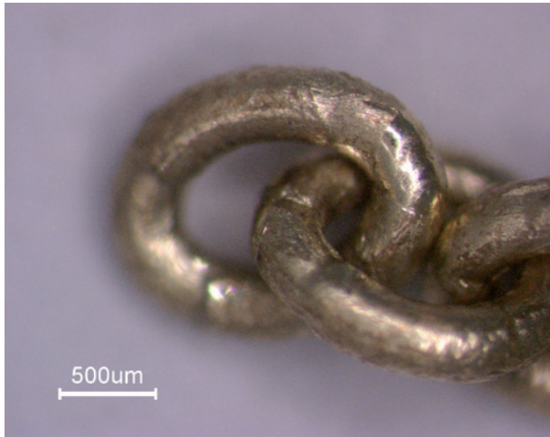
Fig.21- Campione 13 1003 W 2,2 ms - Buccia di arancia molto evidente
