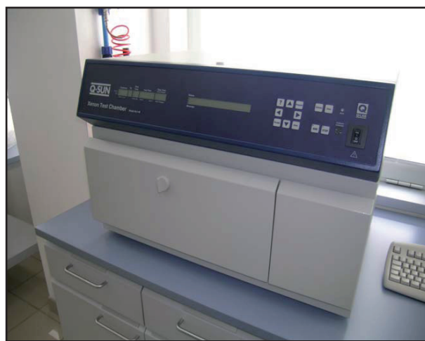
Figura 7 - Lo strumento Q-Sun Xe1B utilizzato durante le prove di invecchiamento
