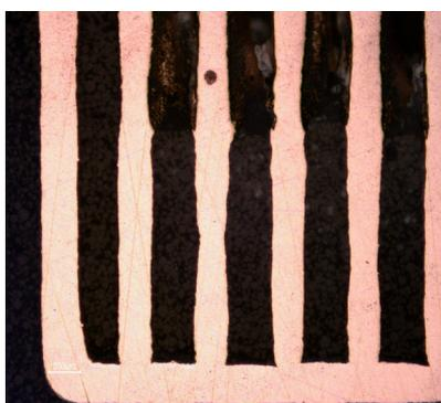
Fig. 14. Vettori con potenza di 82.5 Watt ed tempo di esposizione di 80 ms
