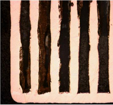
Fig. 9. Vettori con potenza di 92.5 Watt e velocità di scansione di 0.5 m/s
