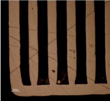
Fig. 5. Vettori con una potenza di 92.5 Watt
