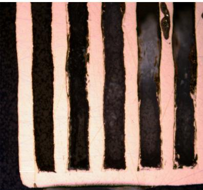
Fig. 10. Vettori con potenza di 82.5 Watt e velocità di scansione di 0.5 m/s
