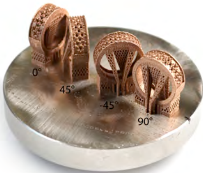
Fig. 12. Le quattro orientazioni dell'anello sulla tavola di lavoro
