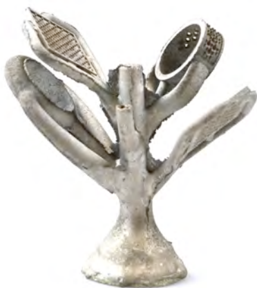
Fig. 30. Alberino in platino 950 ‰ da microfusione diretta
