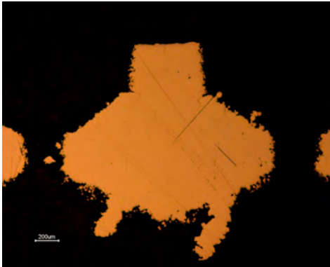
Fig. 37. Dettaglio di una grana del pavè planare in platino prima della sabbiatura
