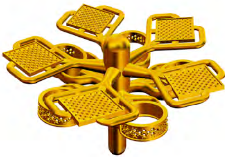
Fig. 14. Rendering dell'albero con gli anelli e tessere pavé
