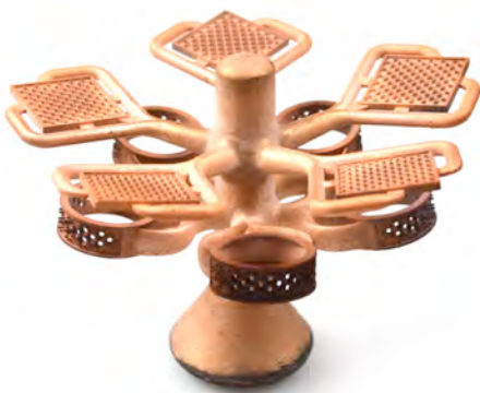
Fig. 27. Alberino in oro rosso 750% da microfusione diretta
