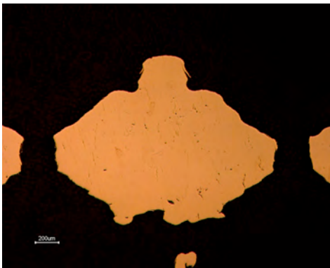
Fig. 38. Dettaglio di una grana del pavè planare in platino dopo della sabbiatura
