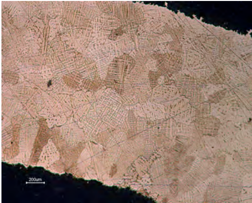
Fig. 43. Microstruttura di una fede massiccia in platino 950‰ microfusa
