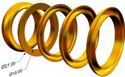
Fig. 16. Fede nuziale intera e sezioni svuotamento con quote
