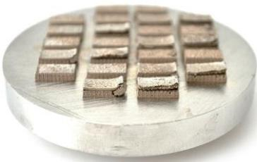
Figura 3 Esempio di campioni con sollevamento delle estremità e distacco dei supporti.
