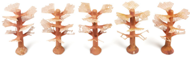
Figura 16 Aspetto degli alberi colati con lega (K) per semplice gravità e con diametro dei fori crescente.
