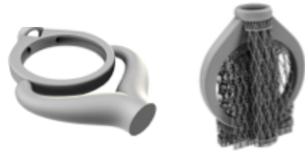
Figura 21. Alimentatori e supporti utilizzati per la produzione dell'anello solitario modello 8
