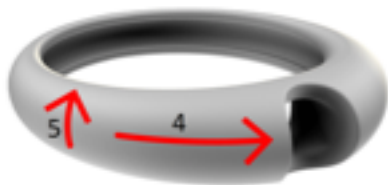
Figura 36. Direzioni di misura della rugosità nei solitari e trilogy microfusi
