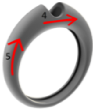
Figura 35. Direzioni di misura della rugosità nei solitari e trilogy SLM™
