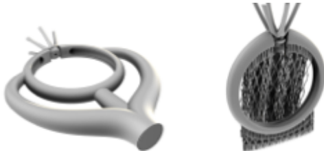
Figura 18. Alimentatori e supporti utilizzati per la produzione dell'anello solitario modello 4
