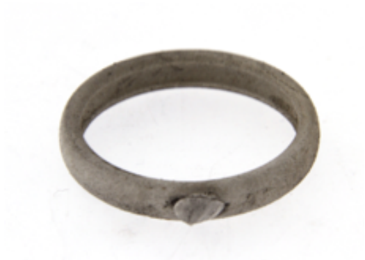
Figura 30. Fede modello 4 grezza prodotta per microfusione
