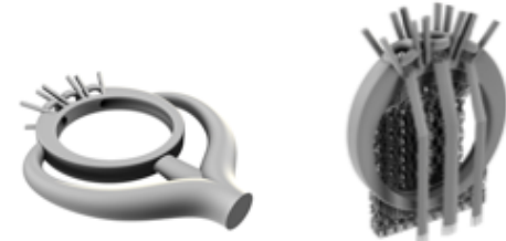
Figura 24. Alimentatori e supporti utilizzati per la produzione dell'anello trilogy modello 1
