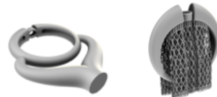
Figura 23. Alimentatori e supporti utilizzati per la produzione dell'anello solitario modello 16
