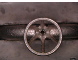
Figura 52. Anello aggiunto per stabilizzare la posizione delle griffe nei solitari 4 microfusi
