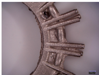
Figura 42. Esempio di rottura del refrattario
