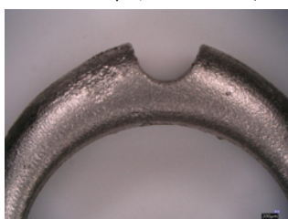
Figura 46. Superficie irregolare in un solitario modello 7 microfuso
