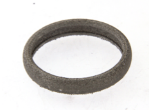
Figura 31. Fede modello 4 grezza prodotta per SLM™
