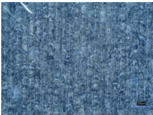
Figura 89. Fede SLM™ "as print" dopo attacco, 200x
