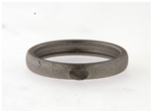
Figura 32. Fede modello 4 prodotta per microfusione, dopo sabbatura
