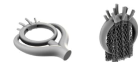
Figura 25. Alimentatori e supporti utilizzati per la produzione dell'anello trilogy modello 2
