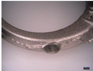
Figura 41. Eccesso di materiale su lato di anello microfuso
