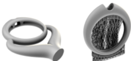
Figura 20. Alimentatori e supporti utilizzati per la produzione dell'anello solitario modello 7
