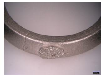
Figura 53. rottura presente in una delle fedi microfuse
