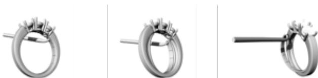
Figura 3. Sequenza cambio parte intercambiabile su Trilogy
