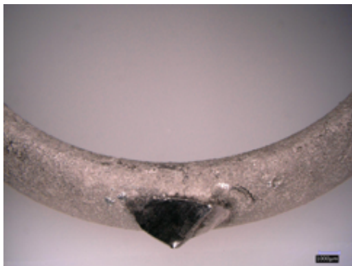
Figura 27. Residuo di alimentazione sulla superficie di un anello
